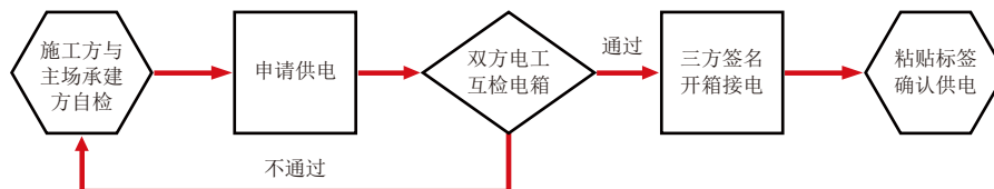
配电箱供电流程图
